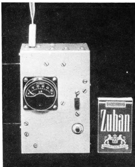
Bild 1. Meßteil der UKW-Wünschelrute. An der Frontplatte befinden sich das Meßinstrument mit Umschalter und der Regler für Ruhestromkompensation. Die Abmessungen des Kästchens betragen 145x92x65 mm
